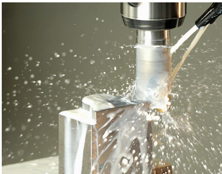
Abbildung 1 Fräser in Aktion mit Kühlschmiermittel
